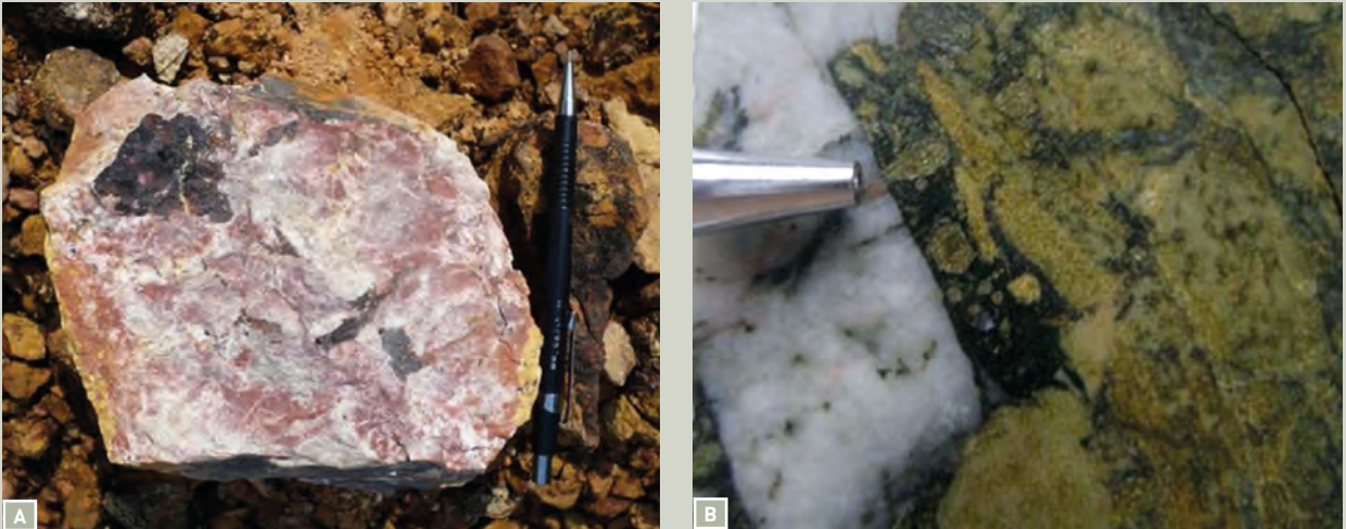
Aspectos macroscópicos das rochas que hospedam a mineralização de ouro no garimpo do Gavião (folha Rio Roosevelt). (A) Bloco de rocha vulcânica com intensa alteração hidrotermal, com nódulos e stockworks preenchidos por sulfetos alterados; (B) Detalhe de testemunho de sondagem mostrando veio cataclástico com fragmentos de sulfetos (calcopirita e pirita).
