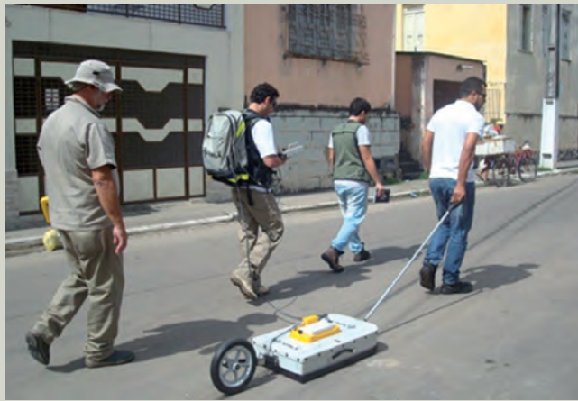
Estudo geofísico pelo método Ground Penetration Radar (GPR), realizado em ruas de Santo Amaro (BA), para medição dos teores de chumbo e cádmio.
